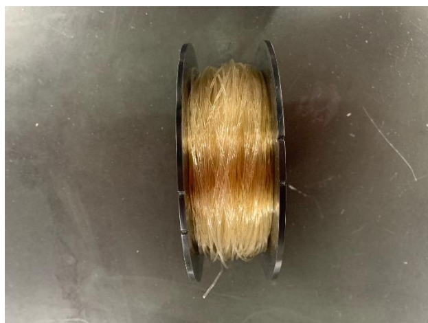
試作したセルロース系生分解性樹脂製の 3D プリンター用フィラメント
