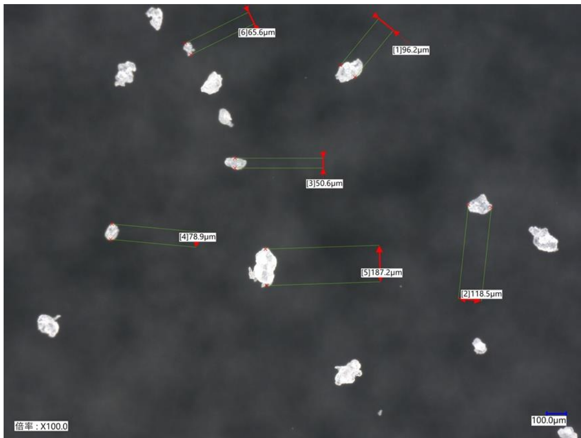
セルロースナノファイバー複合 PLA 樹脂ベースのマイクロビーズ、微粒子の顕微鏡写真
