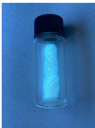
紫外線下でのグラフェン量子ドット +シリカ系無機材料の複合体の粉体
