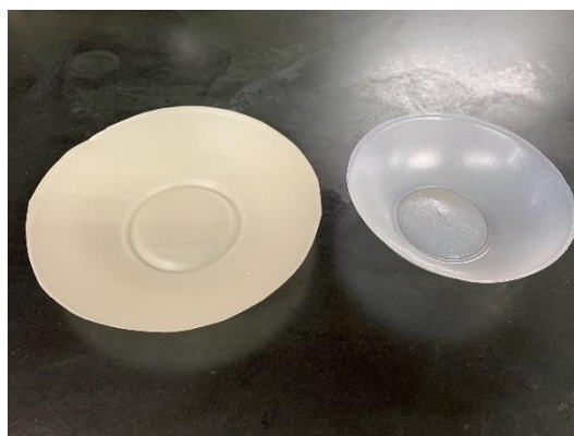
PBS + セルロースナノファイバー複合体を成形した食器(右) 左はデンプン系生分解性プラスチック+CNF
