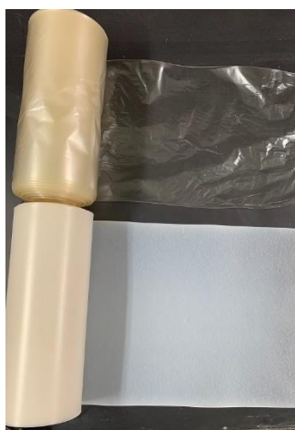
PBS + セルロースナノファイバー複合体フィルム(下) 上は PLA + CNF
