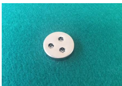
図2. RC2032型のアルミニウム空気電池試作品
